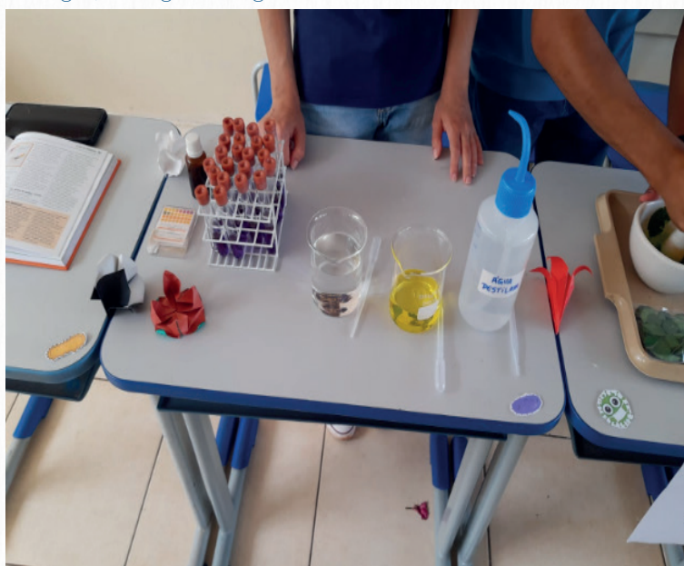
Figura 2. Materiais utilizados na prática da indicação de pH utilizando a mistura da solução de C. ternatea em vinagre, detergente e água destilada.
