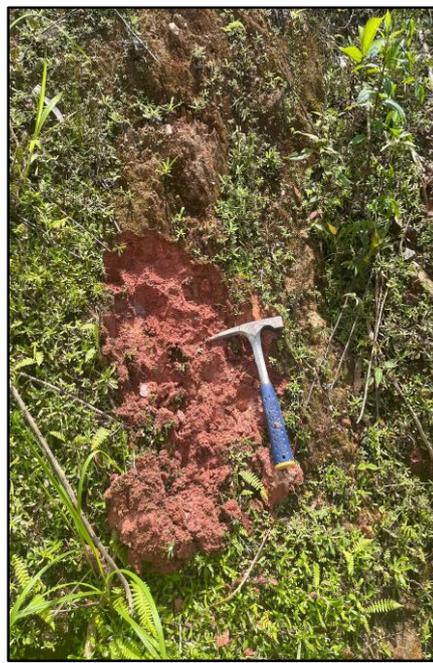
Figura 6 - Solo Saprolítico Muito Intemperizado., com minerais da rocha original totalmente alterados, sem preservação dos componentes originais.
