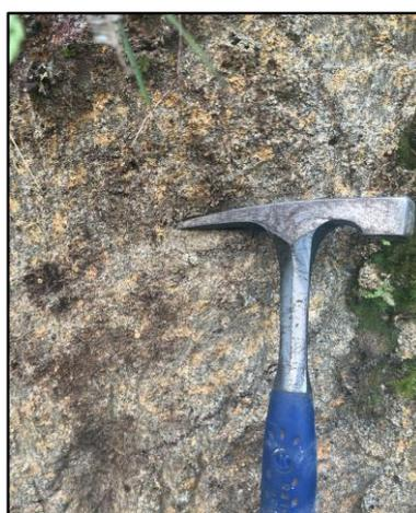
Figura 5 - Afloramento de Solo Saprolítico Pouco Intemperizado, preservando componentes mineralógicos e estruturais da rocha original.
