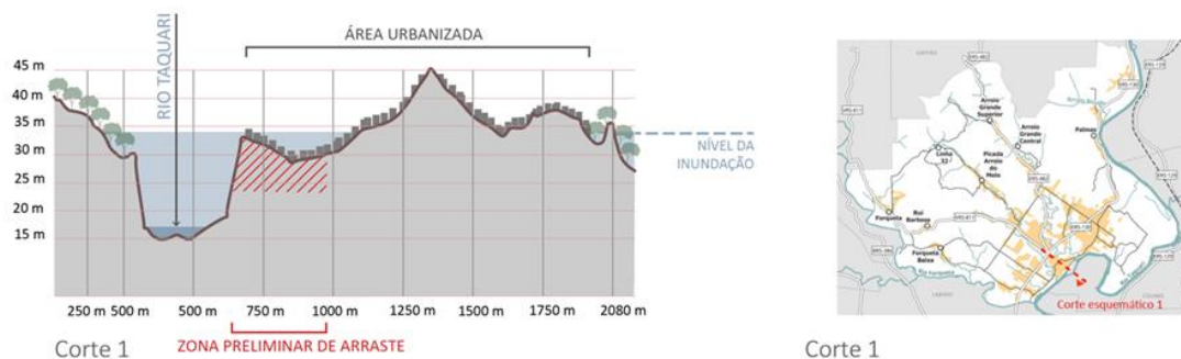
Figura 5: Corte esquemático de situação de inundação em área urbana de Arroio do Meio em maio de 2024.
