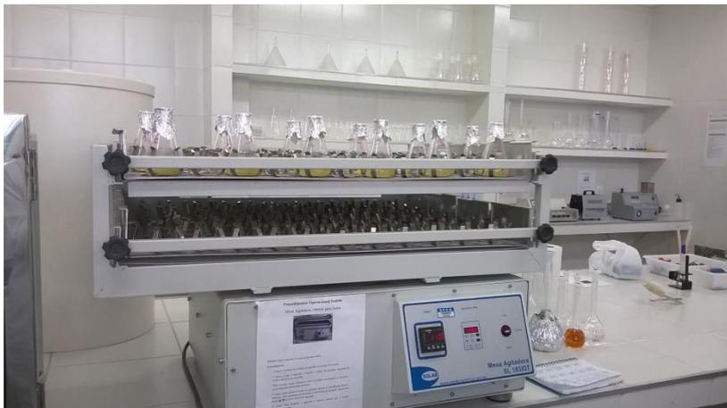
**Figura 2.** Frascos Erlenmeyer contendo a mistura água, óleo e biomassa sob agitação em mesa vibratória a 130 rpm.
