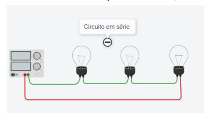
Figura 1- Circuito em série construído no aplicativo *Tinkercad* (AUTODESK, 2024).
