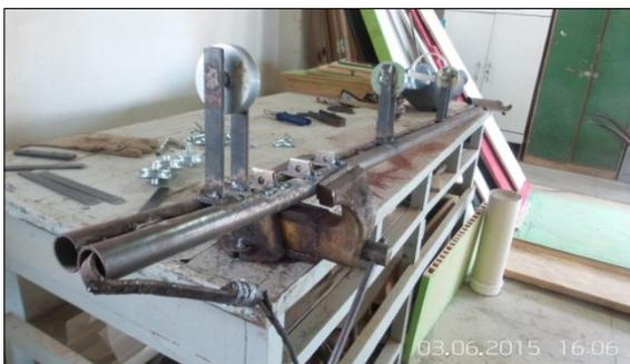
Figura 4 - Soldagem das roldanas
