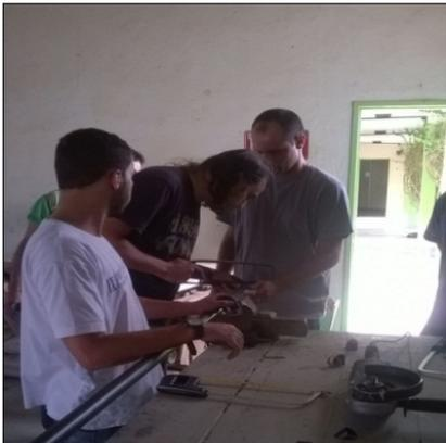
Figura 1 - Corte do tubo patente
