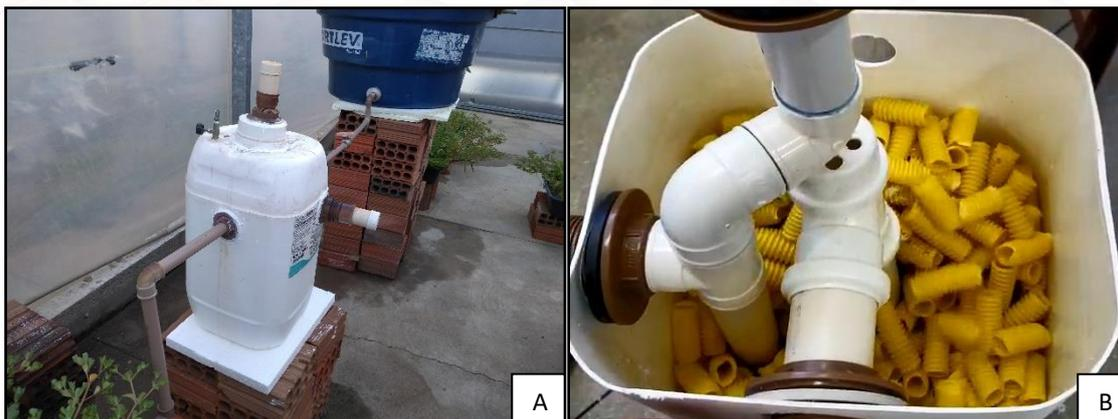
Figura 1. A. Interior do biodigestor com destaque para os eletrodutos flexíveis. B. Biodigestor em operação.
